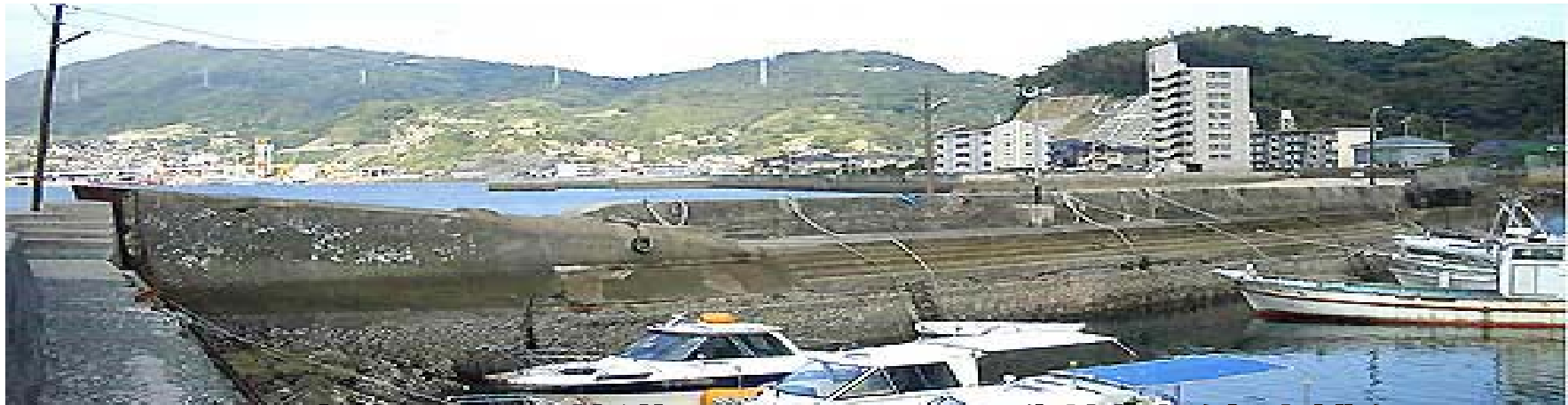
広島県 坪井港 コンクリート製被曳航油槽船
