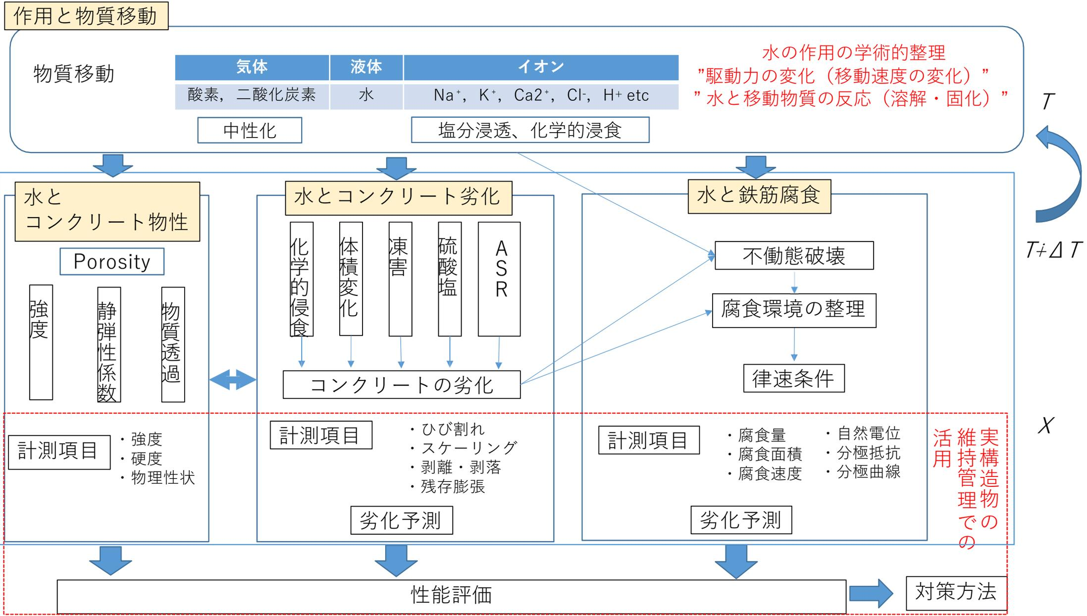
図-1 水を中心としたコンクリート劣化と鉄筋腐食の相関図
