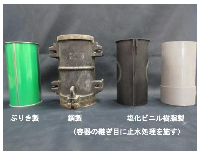
解説写真 1 試験に用いる容器の例
