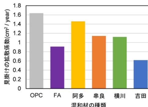
**Fig. 13: Apparent diffusion coefficient of chloride ion**
