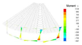
Fig. 8 Cofun C: seismic bending stress (kNm)
