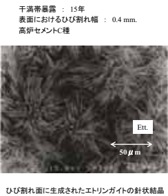
ひび割れ面に生成されたエトリンガイトの針状結晶
