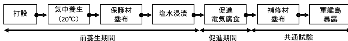
図-2 共通試験のコンクリート試験体の作製フロー
