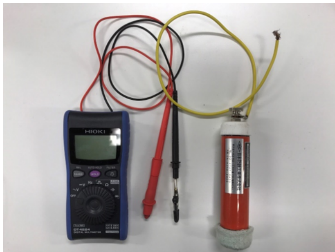
写真-4 自然電位測定装置
