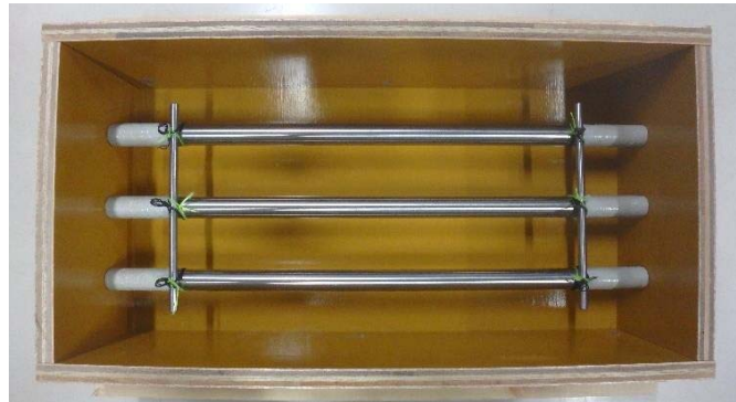
写真-1 鉄筋設置状況（グレードⅢ）
