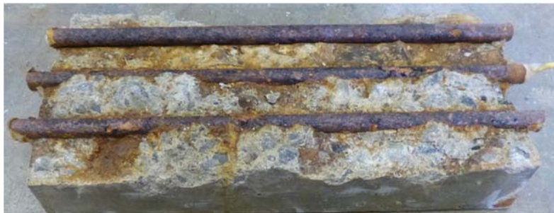
写真-3 グレードⅢ かぶりコンクリートの研り（塩水による腐食促進後）
